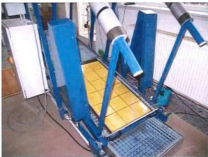
Abb. 1: Prüfgerät „Schiefe Ebene“ mit Kalibrierbelag
